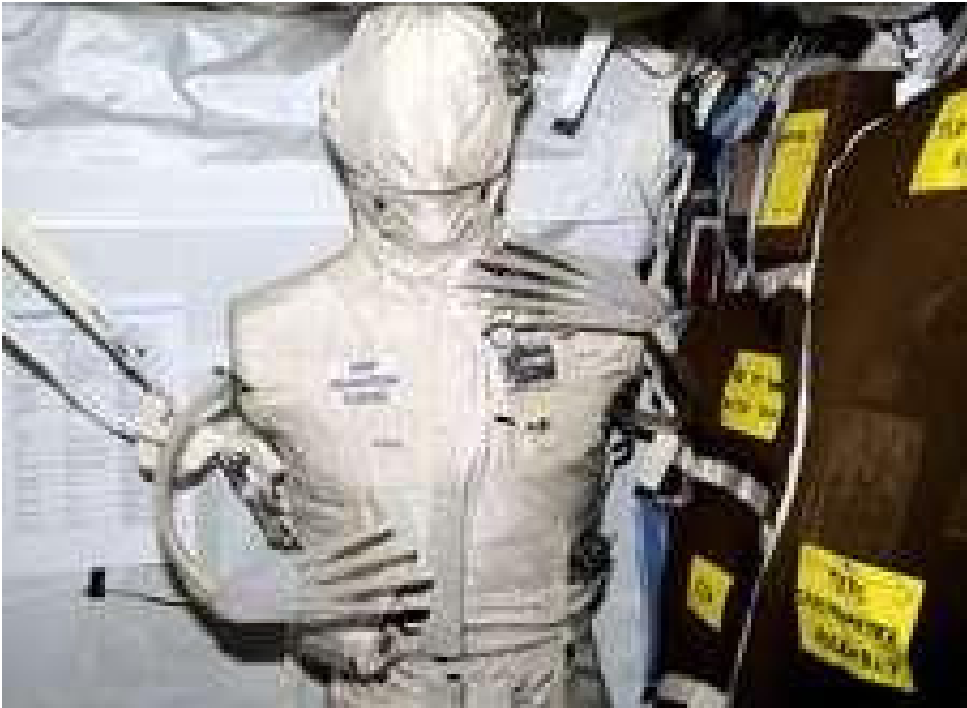
Imagen 35: “Fred”, es el modelo anatómico de una cabeza y un torso humanos. Fred contiene cientos de dispositivos para medir la radiación. Imágen de NASA
