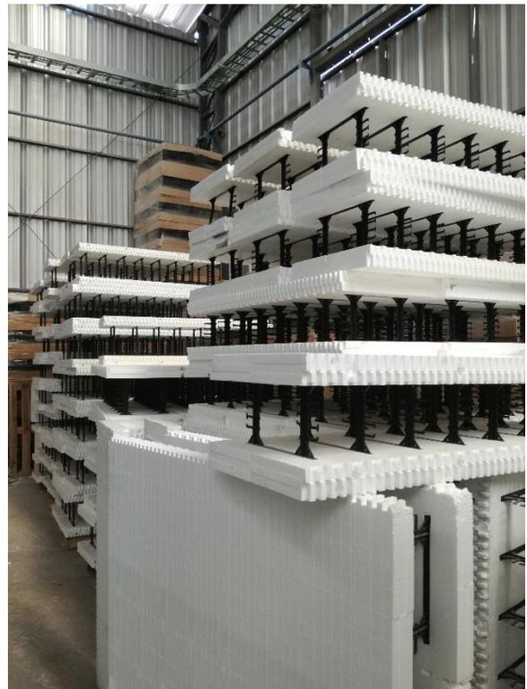
*Figura 2.1.7. Acopio Paneles ICF, COTUX.*
