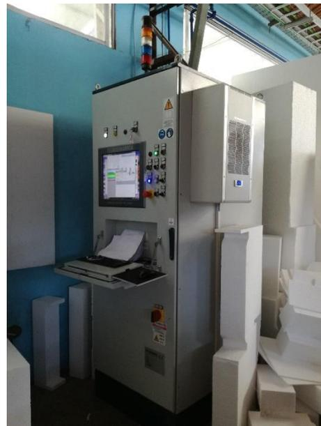
Figura A.4. Máquina de control modeladora.
