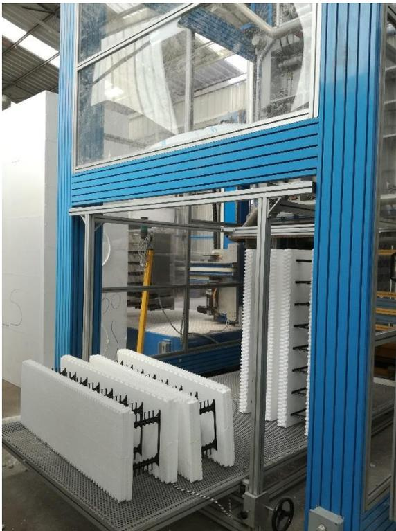
*Figura 2.1.6. Máquina productora de Paneles ICF.*
