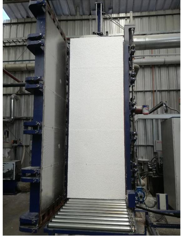
Figura A.10. Bloque Poliestireno Expandido.
