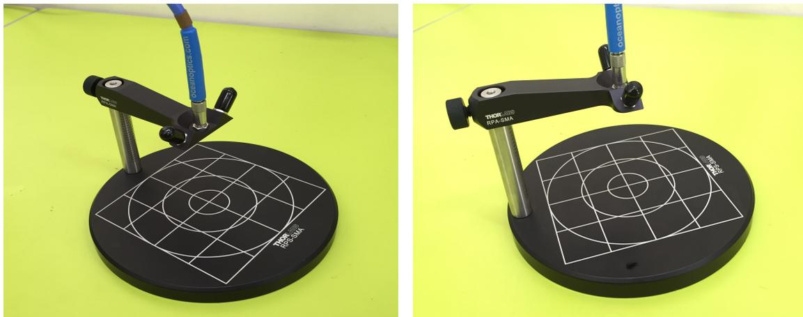
**Figura 3.3:** Montura para la fibra óptica: THORLABS RPS–SMA.
