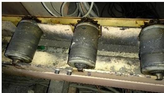
*Figura 2. 5 Rodillos en mal estado*
