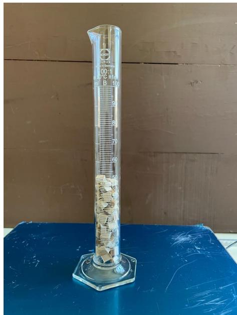
Figura 27: Muestra de leña para medición de densidad
