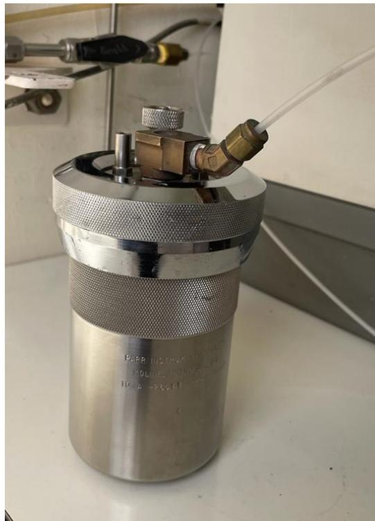
Figura 30: Bomba calorimétrica
