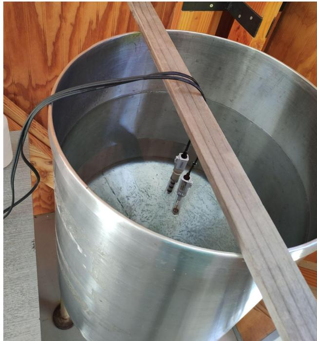
Figura 35: Medición de pH y conductividad al agua desionizada
