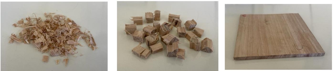
Figura 24: Tipos de muestras utilizadas para los ensayos: viruta, cubos, placa
