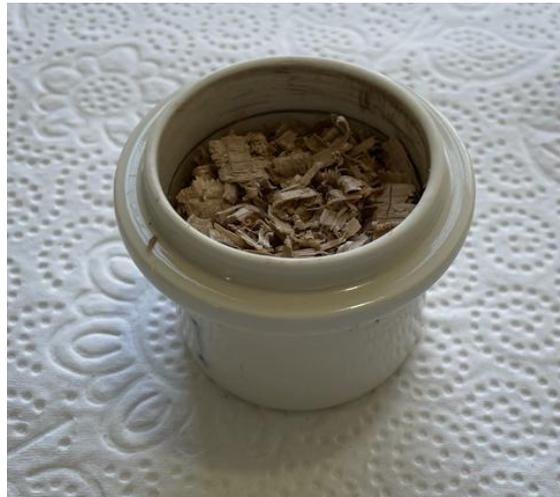
Figura 33: Copa con viruta para ensayo de punto de inflamación
