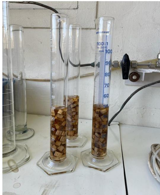
Figura 28: Probetas con triplicados de ensayos de densidad
