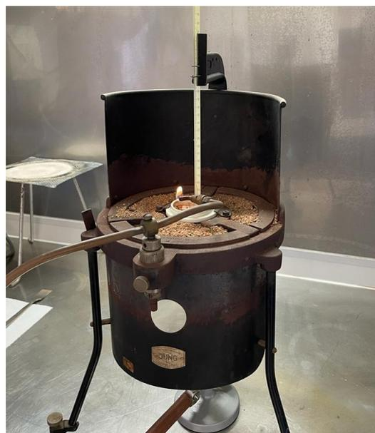
Figura 34: Equipo probador de punto de inflamación
