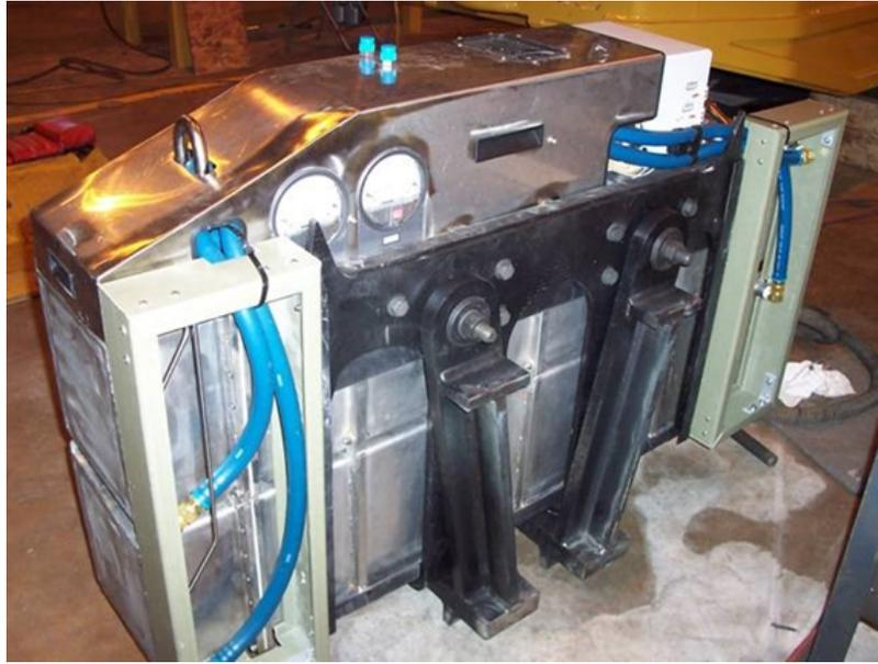
Figura 1.4: Sistema de almacenamiento de hidrógeno marca HERA [7]
