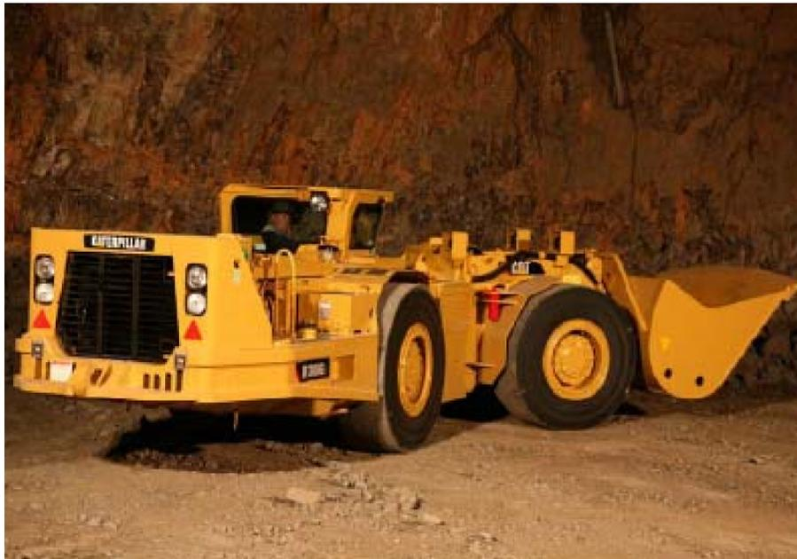
Figura 1.1: Cargador frontal R1300 antes de ser adaptado [7]
