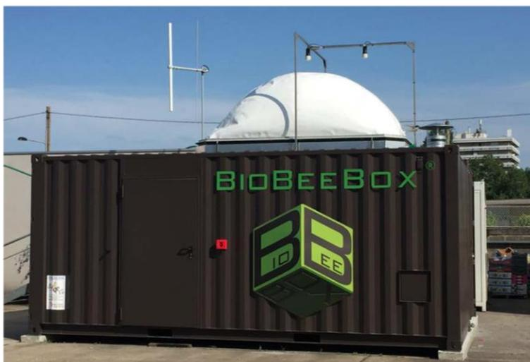
**Figura 5.9.** Micro-metanizador de hasta 300 t/año de la empresa BioBeeBox® en Bordeaux, Francia. El tamaño es comparable al de un contenedor de barco.
