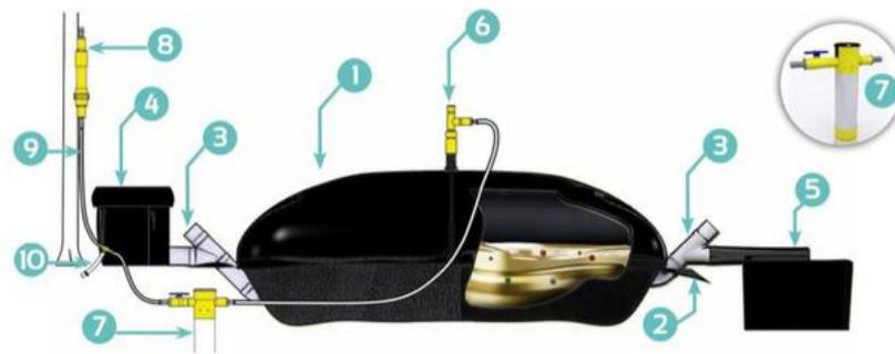
*Figura 5.10. Componentes biodigestor de polietileno [45].*
