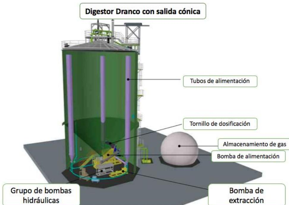
Figura 3.3 Digestor Dranco® con salida cónica [15].
