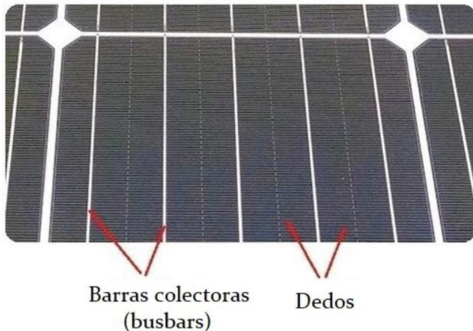
Figura 3.2: Barras colectoras y dedos de un modulo solar.Fuente: Solaragazine
