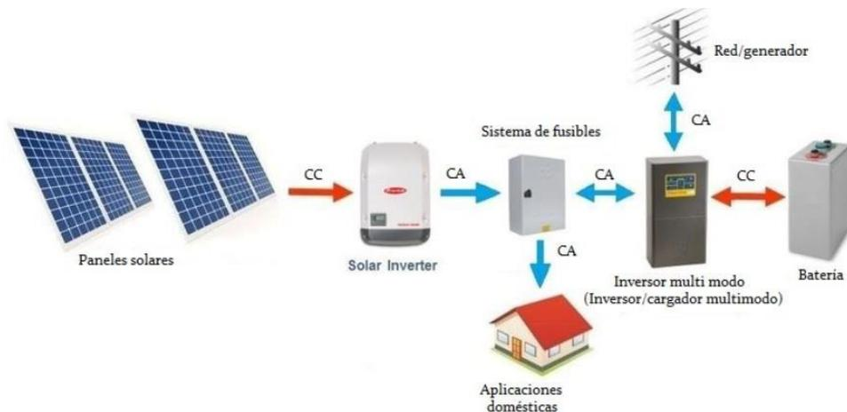
Figura 3.16: Esquema básico de un sistema acoplado de CA con sistemas de baterías híbrido conectado a la red. Fuente: Clean Energy Reviews
