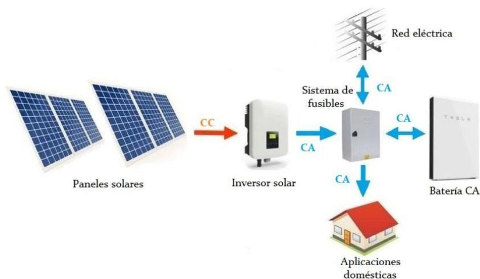
Figura 3.17: Diagrama básico de un sistema con baterías de corriente alterna (CA) con un sistema solar de corriente alterna, conectado a la red. Fuente: Clean Energy Reviews
