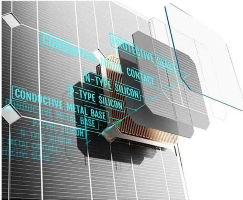
Figura 3.1: Ilustración 3D general de la estructura de un panel solar. (Fuente: Solaragazine)
