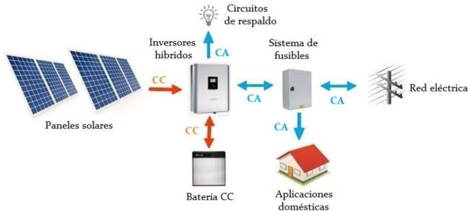
Figura 3.18: Diagrama básico de un sistema de inversor solar híbrido con baterías de corriente continua (CC).Fuente: Clean Energy Reviews
