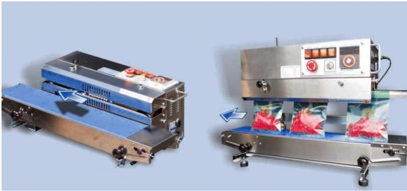
**Figura 15:** Termo-sellado equipo semi-automático.
