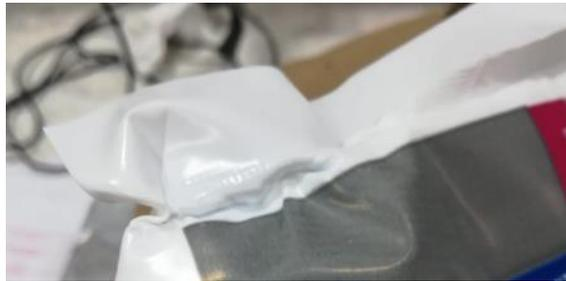
**Figura 17:** Bolsa con arruga por exceso de calor.
