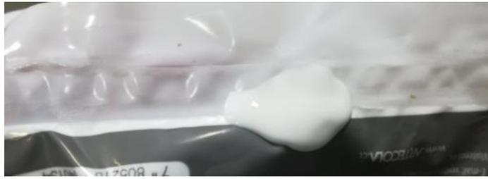
**Figura 16:** Bolsa con filtración.
