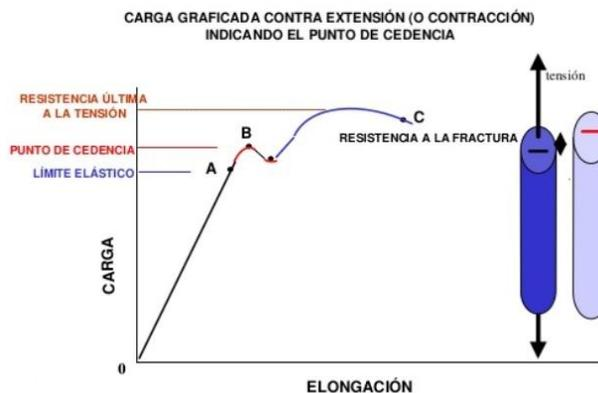
Figura 3-5.- Resistencia ultima del material
