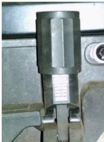
Figura 4.10 tornillo en posición vertical encargado de sujetar el filamento
