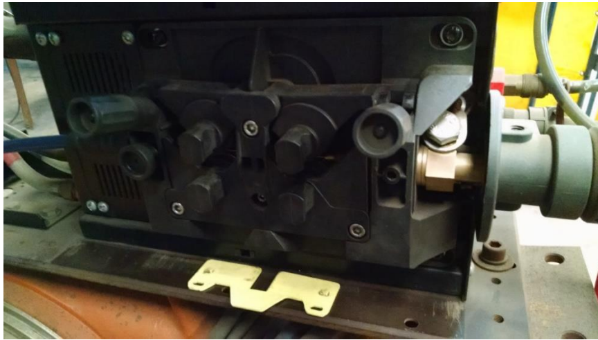
Figura 4.7 placa de seguridad extraído y tornillos en posición horizontal
