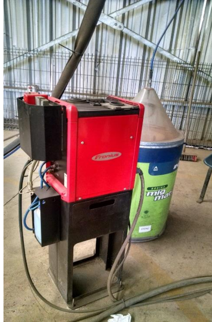
Figura 1.5 Sistema de limpieza de torcha automática, Fronius, Mc Robacta TC 1000
