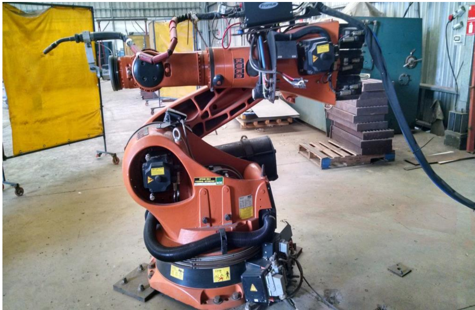
Figura 1.2 Brazo Robótico Kuka KR-150 con sistema de soldadura integrado En: RILAN LTDA (3638, Golfo de Arauco, Coronel, Región del Bío Bío)
