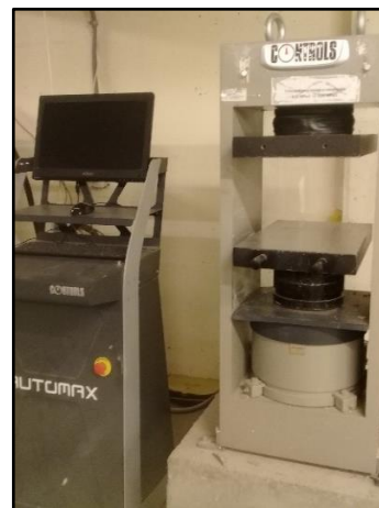
Equipo Controls C35Z00 para ensayo de compresión.
