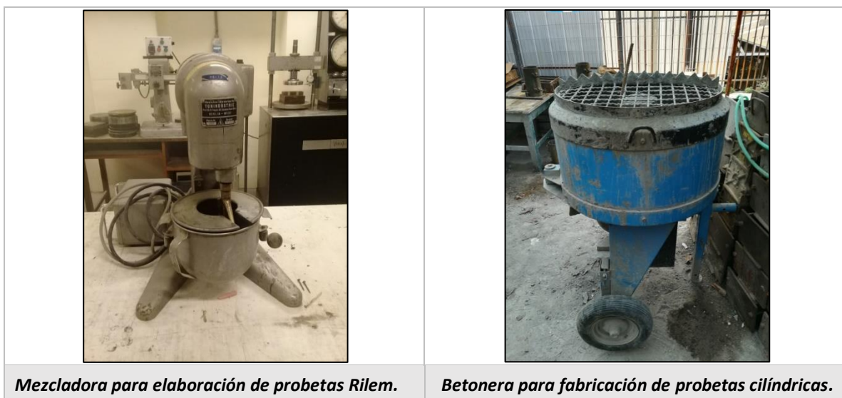
Ilustración 7.-Máquinas utilizadas para elaboración de las mezclas de mortero.
