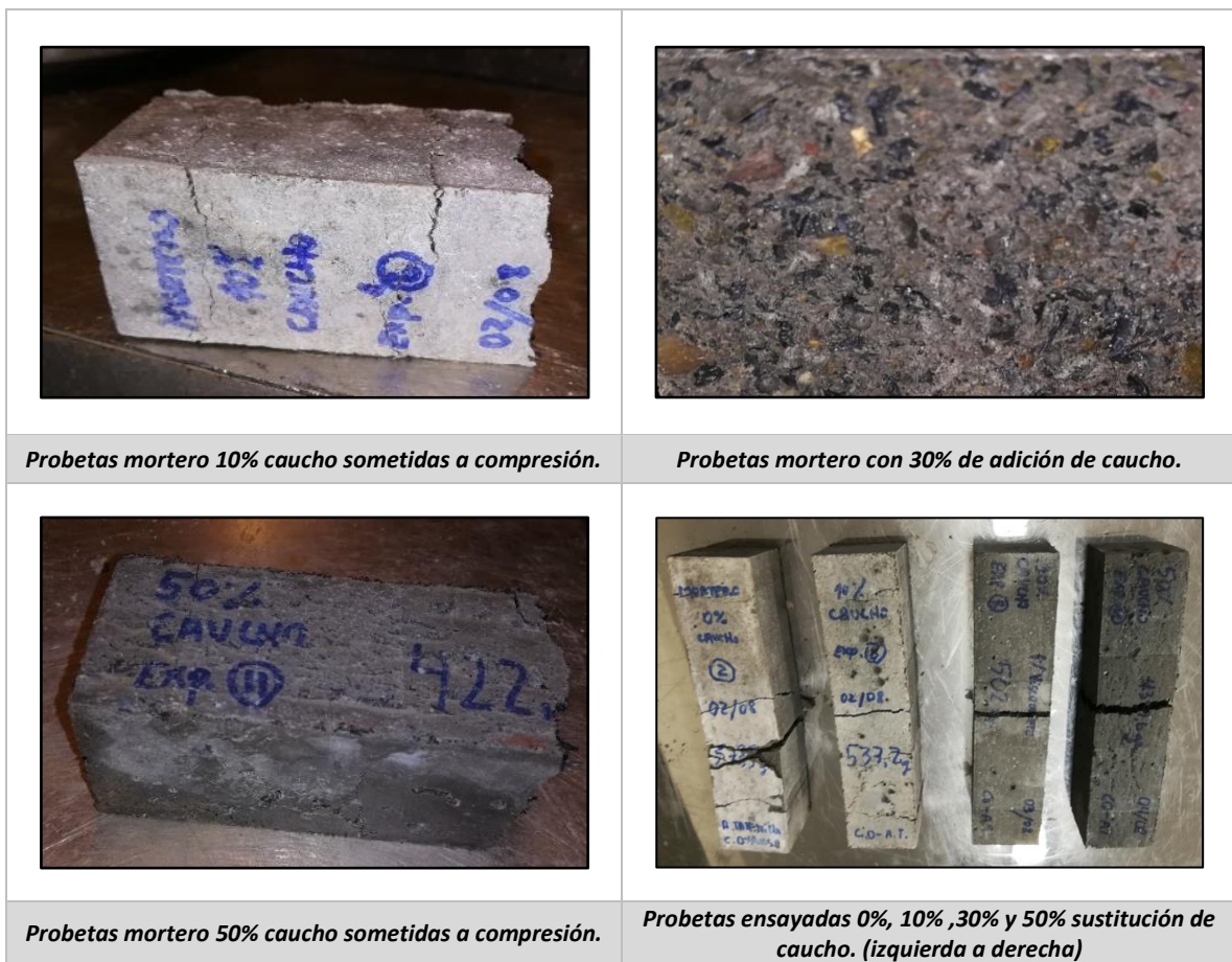
Ilustración 15.-Probetas prismáticas de mortero con agregado de caucho ensayadas a compresión.
