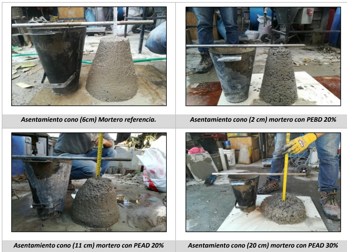
Ilustración 10.-Asentamiento de cono de Abrams para morteros con agregados de PEAD y PEBD.
