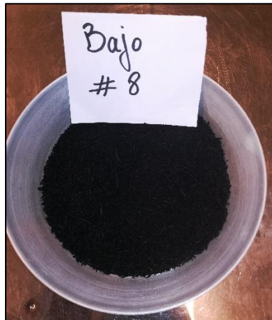
Ilustración 3.-Caucho proveniente recauchado de neumático fuera de uso.
