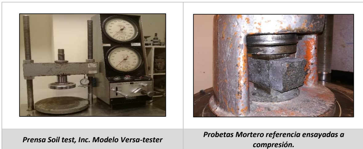
Ilustración 14.-Equipos utilizados para ensayo a compresión de probetas prismáticas.
