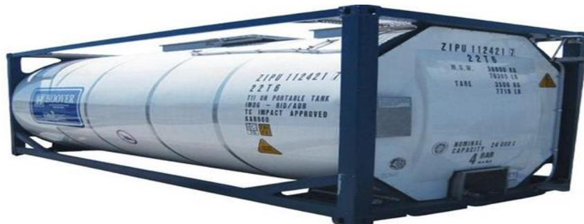
Figura 1-5. Contenedor tipo Tank
