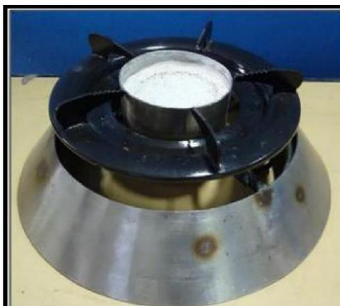
*Figura 2.4: Quemador estabilizado en superficie desarrollado por Mujeebu [15].*
