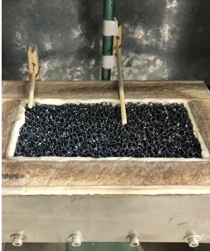
*Figura 3.22: Termopar tipo S instaladas sobre MPI.*
