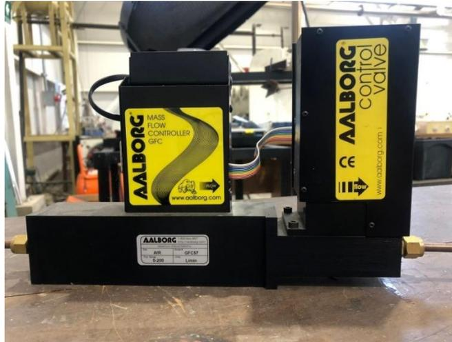
*Figura 3.18: Controlador de flujo másico para aire.*
