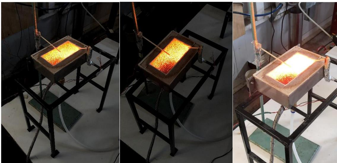
*Figura A.43: Quemador funcionando con 15% (izquierda) y 16% (centro y derecha) de la potencia aportada por hidrógeno y efecto de retroceso de llama.*
