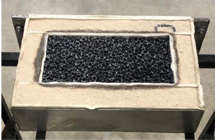
*Figura 3.20: Quemador de MPI.*
