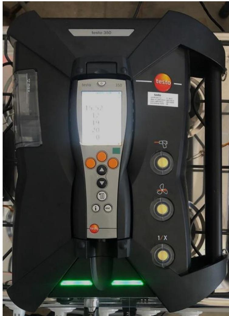
*Figura 3.25: Sensor de gases H<sub>2</sub>, CO, CO<sub>2</sub> y NO<sub>x</sub>.*
