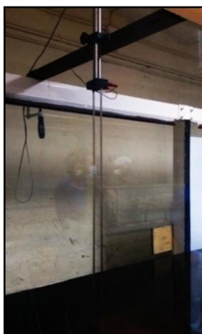
**Figura 3.12:** Sonda de medición resistiva.
