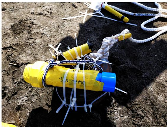
Figura 4.11: Sensores de Presión OWHL 3 y HOBO en el punto M
