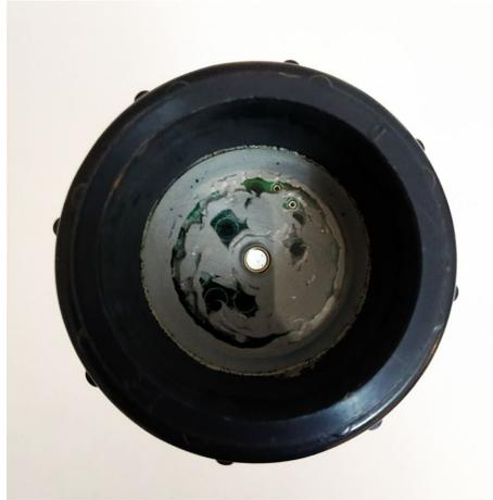
Figura A.10: Sensor de presión OWHL
