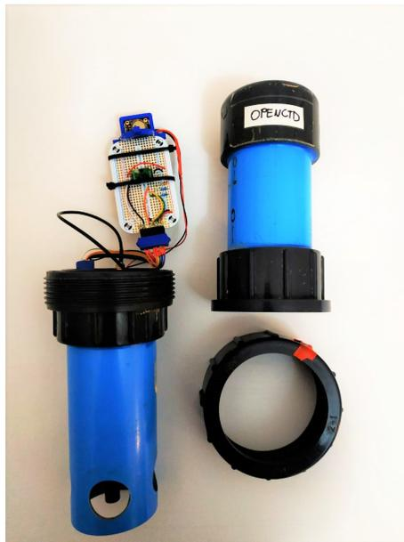
Figura A.7: Partes e interior del OpenCTD
