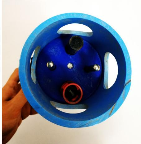
Figura A.6: Sensores del OpenCTD
