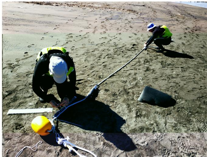
Figura 4.16: Instalación de los YSI en superficie y profundidad en la cuerda guía para la estación A
