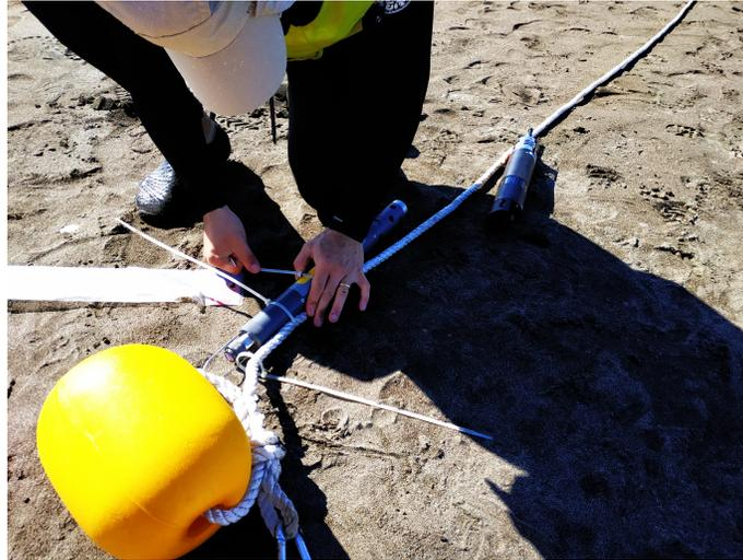
Figura 4.17: Instalación del YSI en superficie
