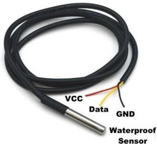
Figura 2.5: Sensor DS18B20 con sistema para inmersión en líquidos.
