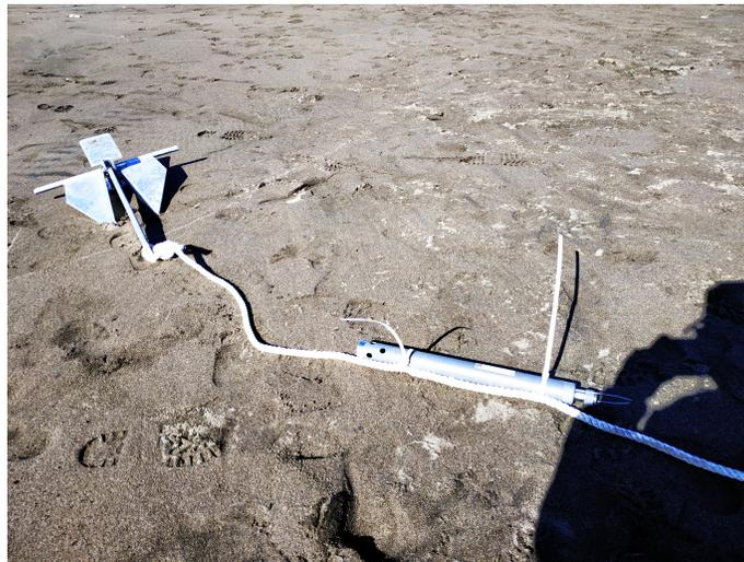
Figura 4.18: Instalación del YSI en profundidad junto al ancla
