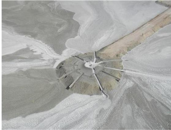
*Ilustración 12. Descarga de Relaves Singular*
