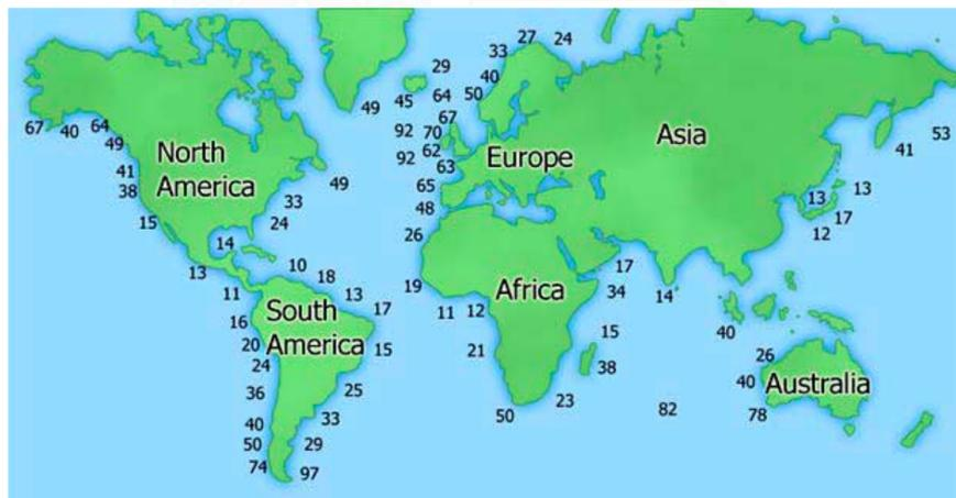
**Figura 5.5:** Distribución de energía de las olas en mar abierto expresada en kW por metro de frente de onda.
