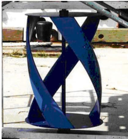
**Figura 6.20:** Turbina helicoidal de Gorlov.
