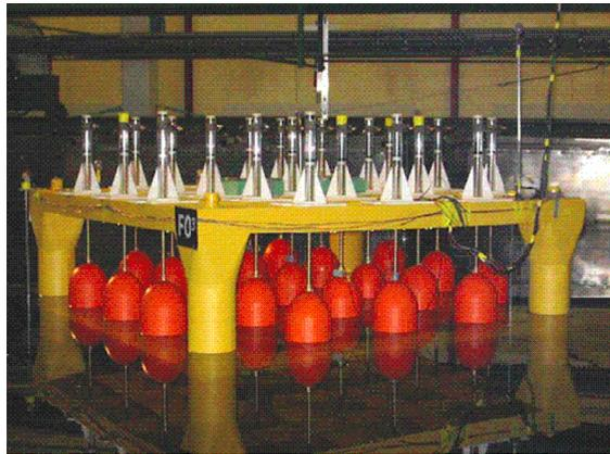
**Figura 6.16:** Modelo de prueba de un FO3.
