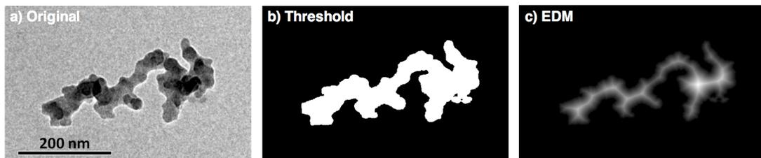
**Figura 4.3:** Tratamiento de imagen, para una imagen TEM de etileno  $OI = 25$ ,  $HAB = 30$  mm.
