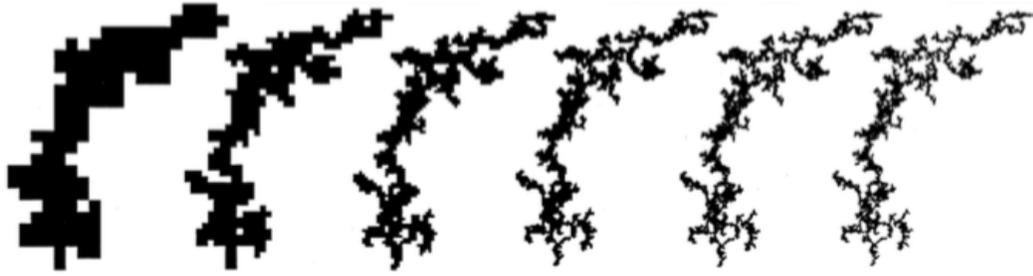
**Figura 2.16:** Método de box counting de una imagen de un agregado numérico. Se tienen resoluciones de 32, 16, 8, 4, 2 y 1 pixel, los cuadrados necesarios son 131, 386, 1198, 3816, 12578 y 42397, respectivamente. Fuente: [13]
