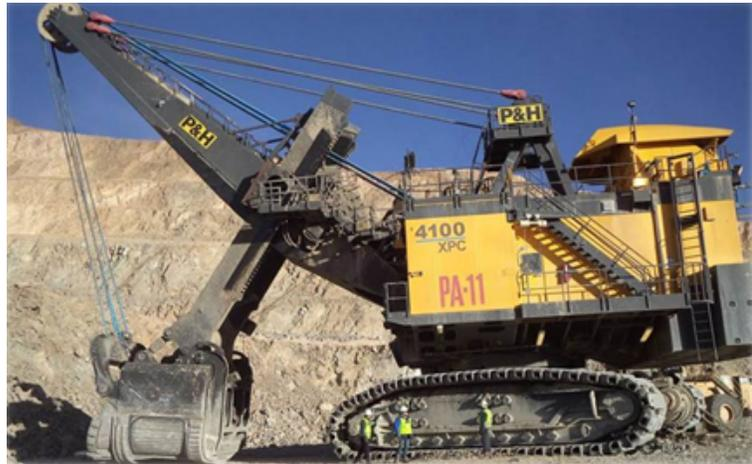
Figura 3.3: Pala electromecánica P&H modelo 4100XPC
