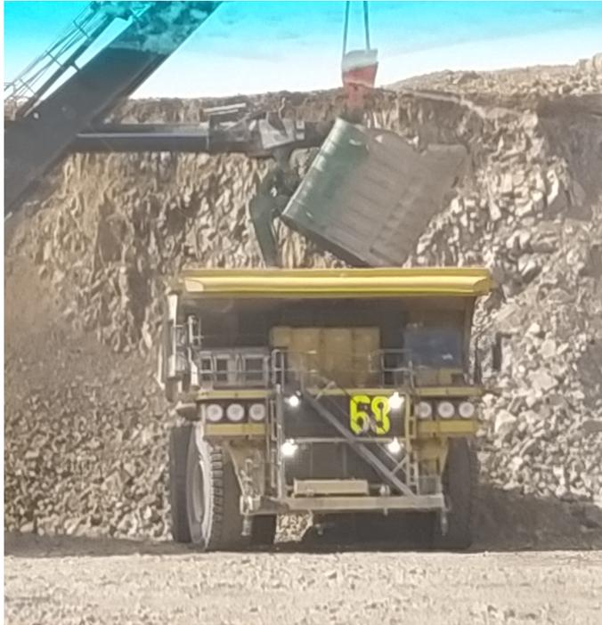
Figura 3.1: Pala electromecánica cargando CAEX
