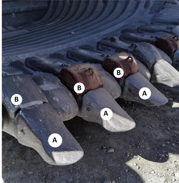
Figura 3.4: Dientes y Tapa de desgaste A) Diente; B) Tapa de desgaste
