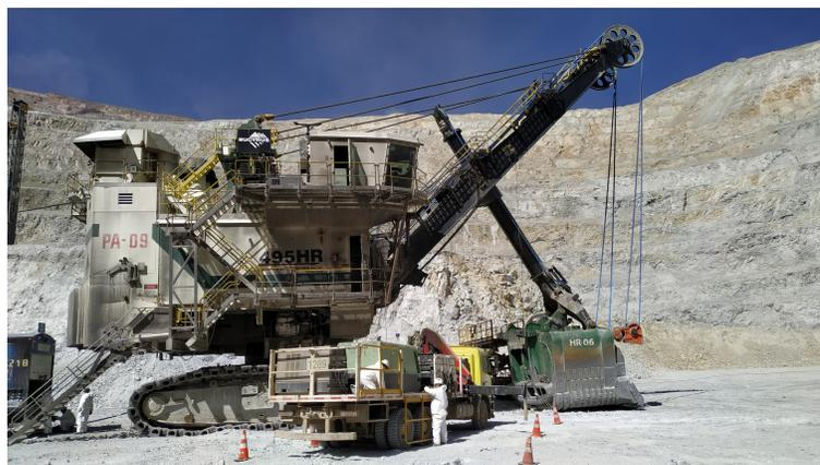
Figura 3.2: Pala electromecánica Bucyros modelo 495HR
