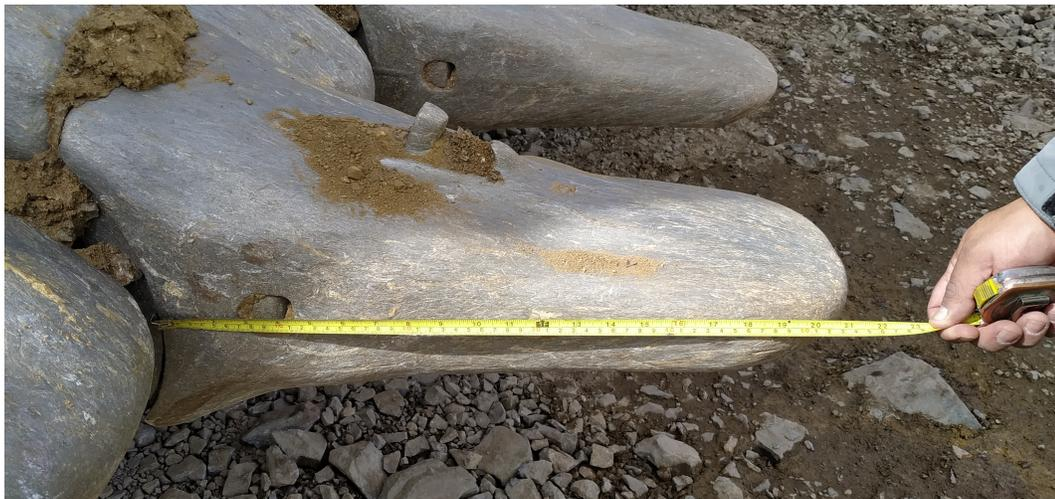
Figura 4.3: Personal de mantenimiento realizando inspección a dientes
