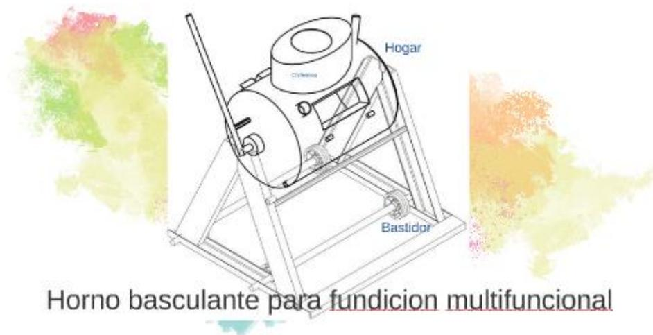
Horno basculante para fundición multifuncional
