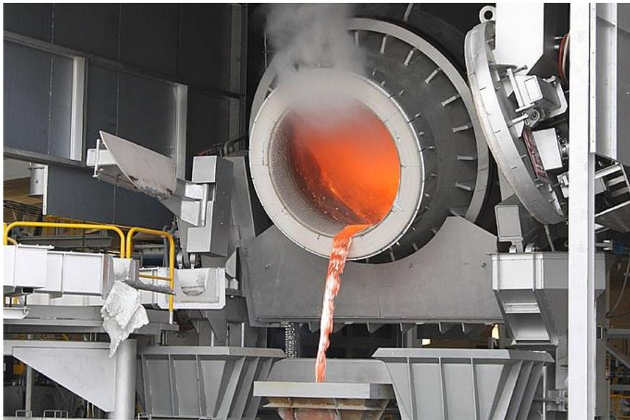
Ilustración 1: Horno basculante
