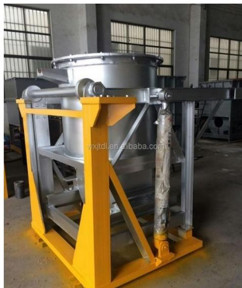
Ilustración 3: Horno basculado mediante sistema de pistones hidráulicos
