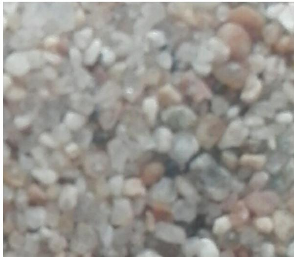
**Figura 3.14:** Foto de granito meteorizado utilizado en los ensayos triaxiales
