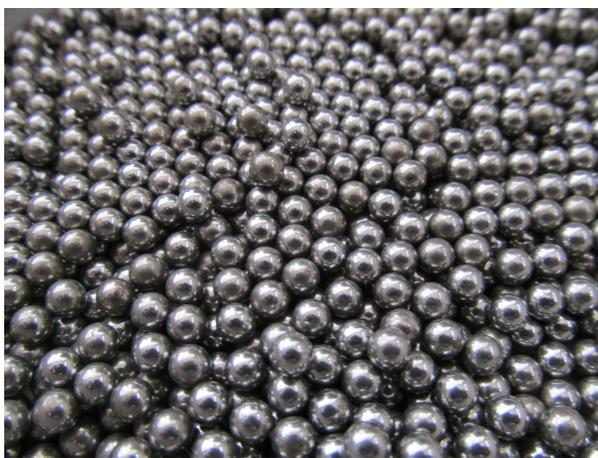
**Figura 3.12:** Foto de rodamientos de acero utilizados en los ensayos triaxiales
