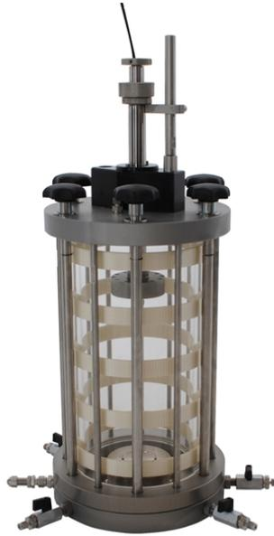
**Figura 3.4:** Cámaras Triaxiales, diámetro  $\phi = 200[mm]$
