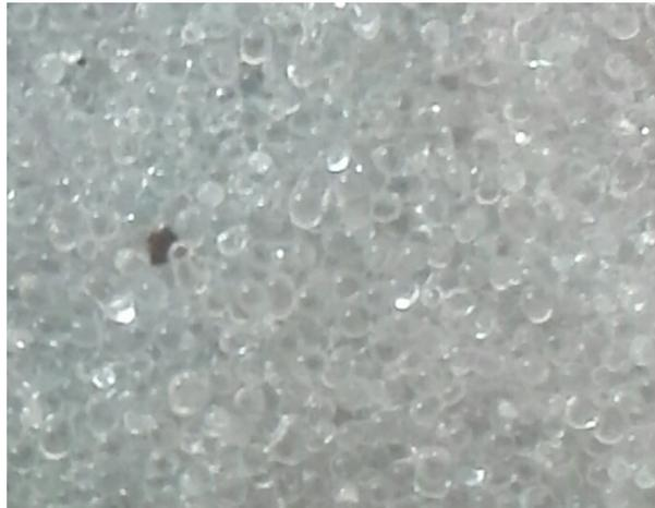
**Figura 3.13:** Foto de microesferas de vidrio utilizadas en los ensayos triaxiales
