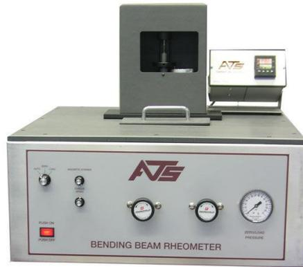
*Figura 2-5: Reómetro de flexión de viga (BBR).*
