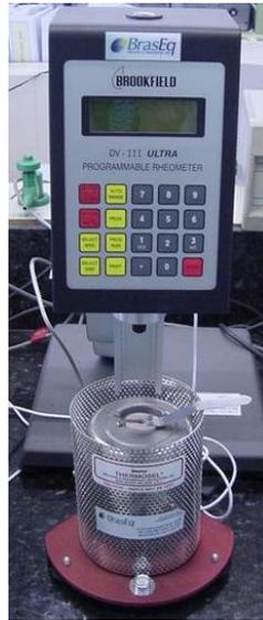
Figura 2-3: Viscosímetro rotacional (RV).
