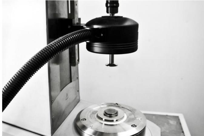
Figura 2-4: Reómetro de corte dinámico (DSR).
