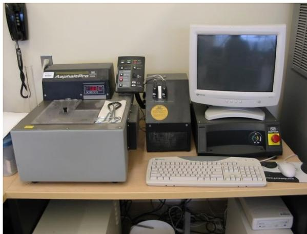
*Figura 2- 6: Equipo de ensayo de tracción directa.*
