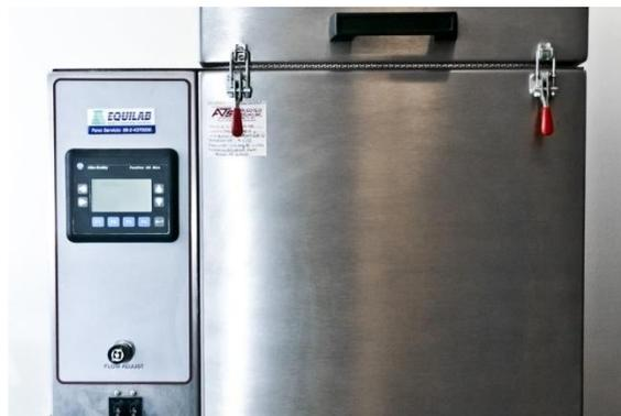
Figura 2-2: Cámara de envejecimiento a presión (PAV).
