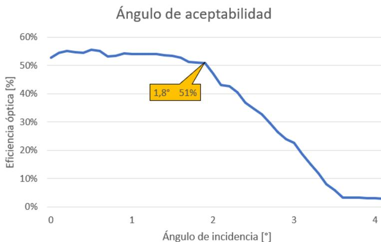
Figura 2.13: Gráfico Eficiencia v/s Ángulo de incidencia
