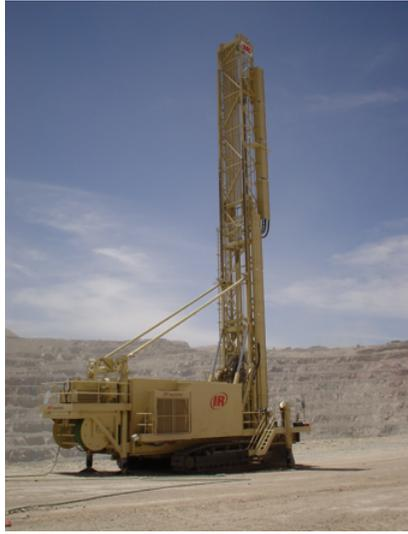
Figura 3.6: Equipo de perforación Pit Viper 351. (fuente: Capacitación equipos Drilling Solutions, 2006.)
