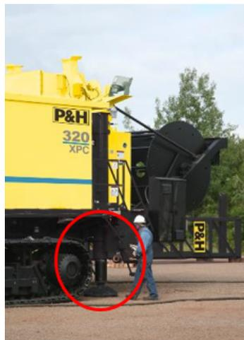
Figura 3.12: Esquema de sistema de nivelación en perforadora P&H 320XPC. (fuente: Curso de Instructores Mina Caserones)
