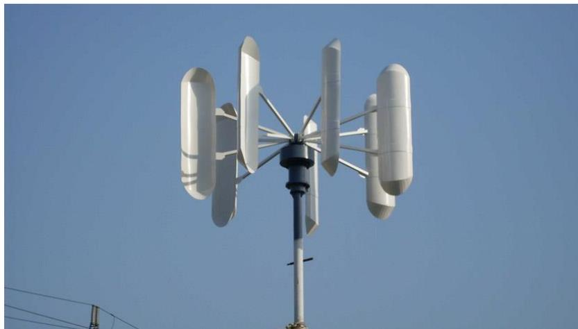
*Nota:* Representación de un aerogenerador vertical tipo Giromill. Fuente: LBA Industrial, 2021.
