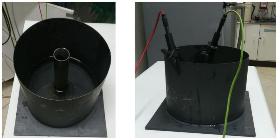
Figura 12 a) Celda de acero con salmuera; b) electrodos conectados a la celda.
