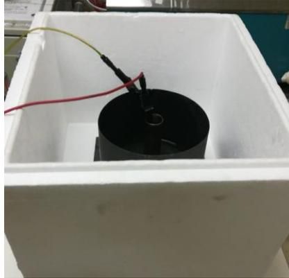
Figura 13 Caja de poliestireno expandido como aislante para el experimento.
