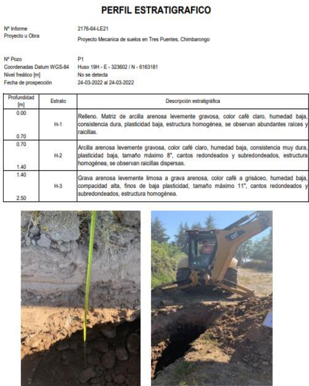
Figura 2-13. Perfil estratigráfico
