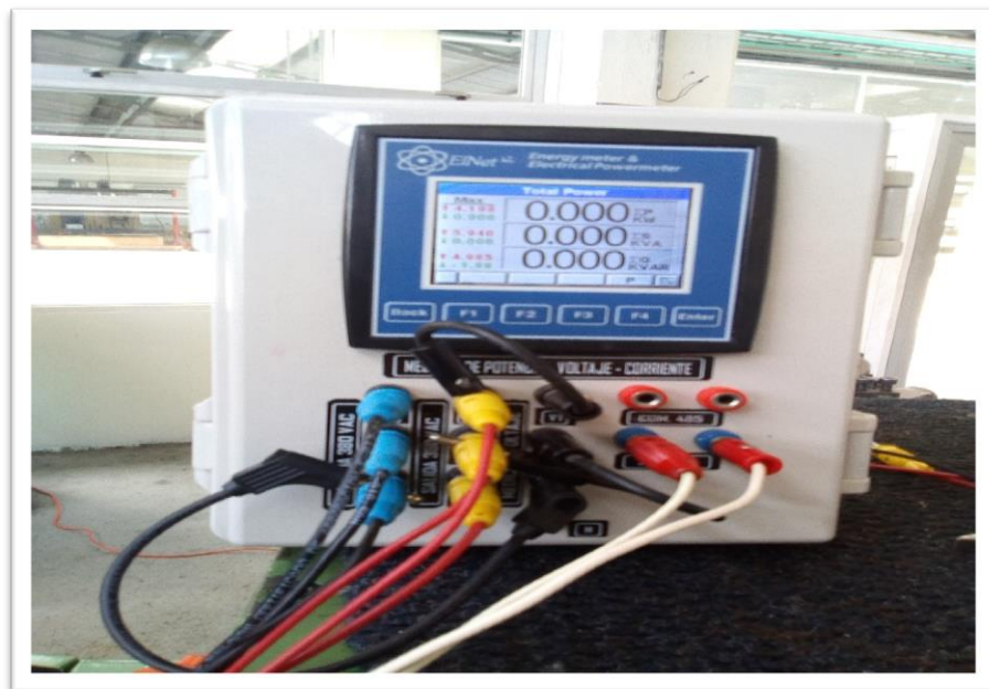
Figura 2. 7. Analizador de red utilizado en el ensayo.
