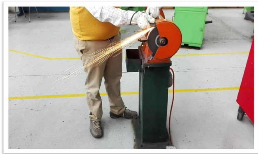
Figura 2. 10. Ensayo de chispa realizado al material de trabajo.
