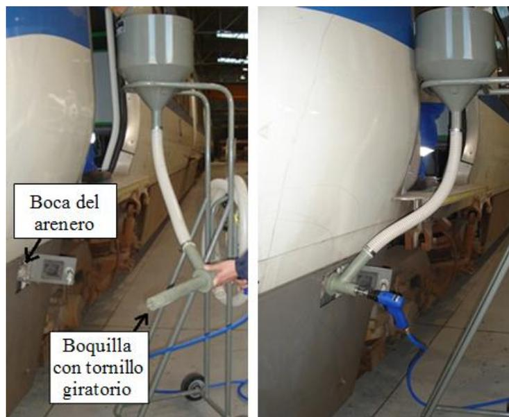
**Figura 1.3:** Fotografías de un alimentador de arena mediante tornillo giratorio. A la izquierda se indica la boca del arenero y la ubicación de la boquilla donde se encuentra el tornillo giratorio. A la derecha se muestra el alimentador con su boquilla insertada en el arenero [3].
