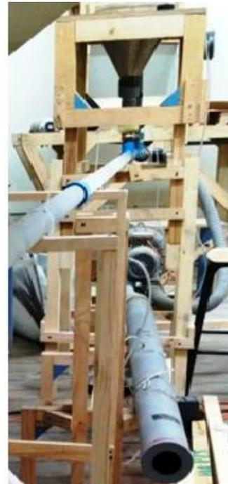
**Figura 3.4:** Fotografías de la cañería horizontal de transporte.
