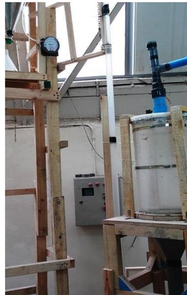
**Figura 3.6:** Fotografías del punto de alimentación y de la cañería de transporte vertical.
