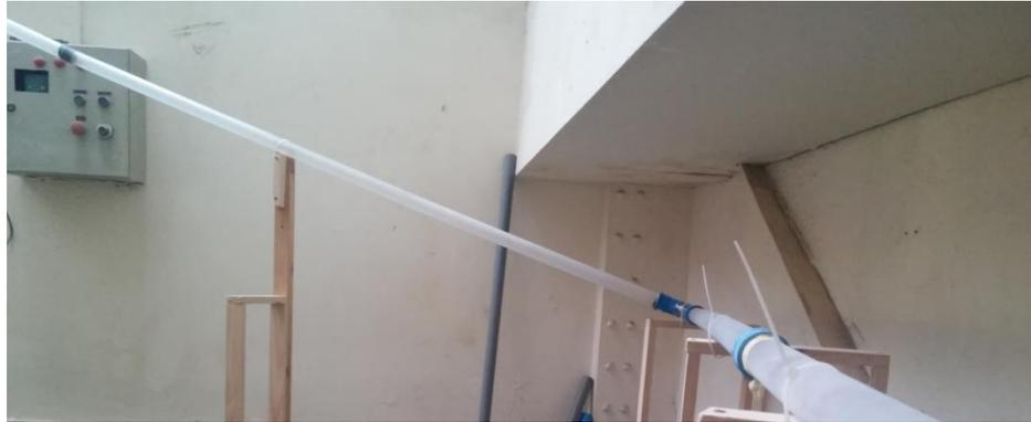
**Figura 3.8:** Fotografía del cambio de dirección de cañería horizontal a inclinada.
