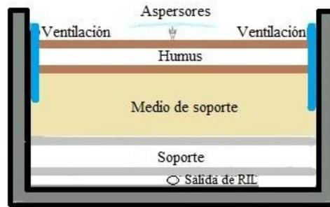
Figura 4: Diagrama biofiltro con Sistema Tohá.
