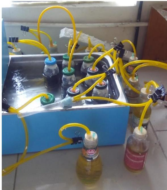
Figura 10: Montaje de reactores a escala de laboratorio empleados en los ensayos
