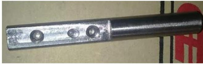
**Figura 3.4.** Portagrillas TEM que sirve de extensión al vástago del actuador.
