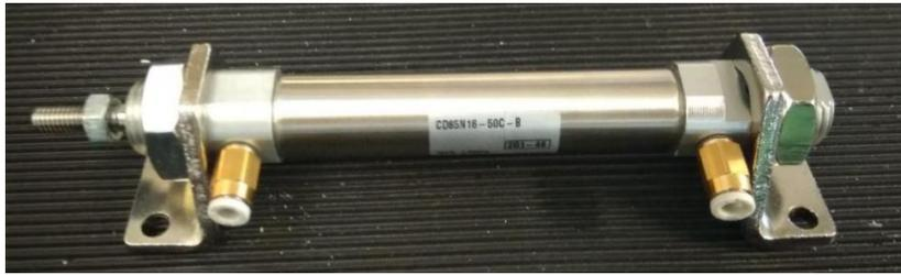
**Figura 3.2.** Actuador neumático SMC C85 empleado.
