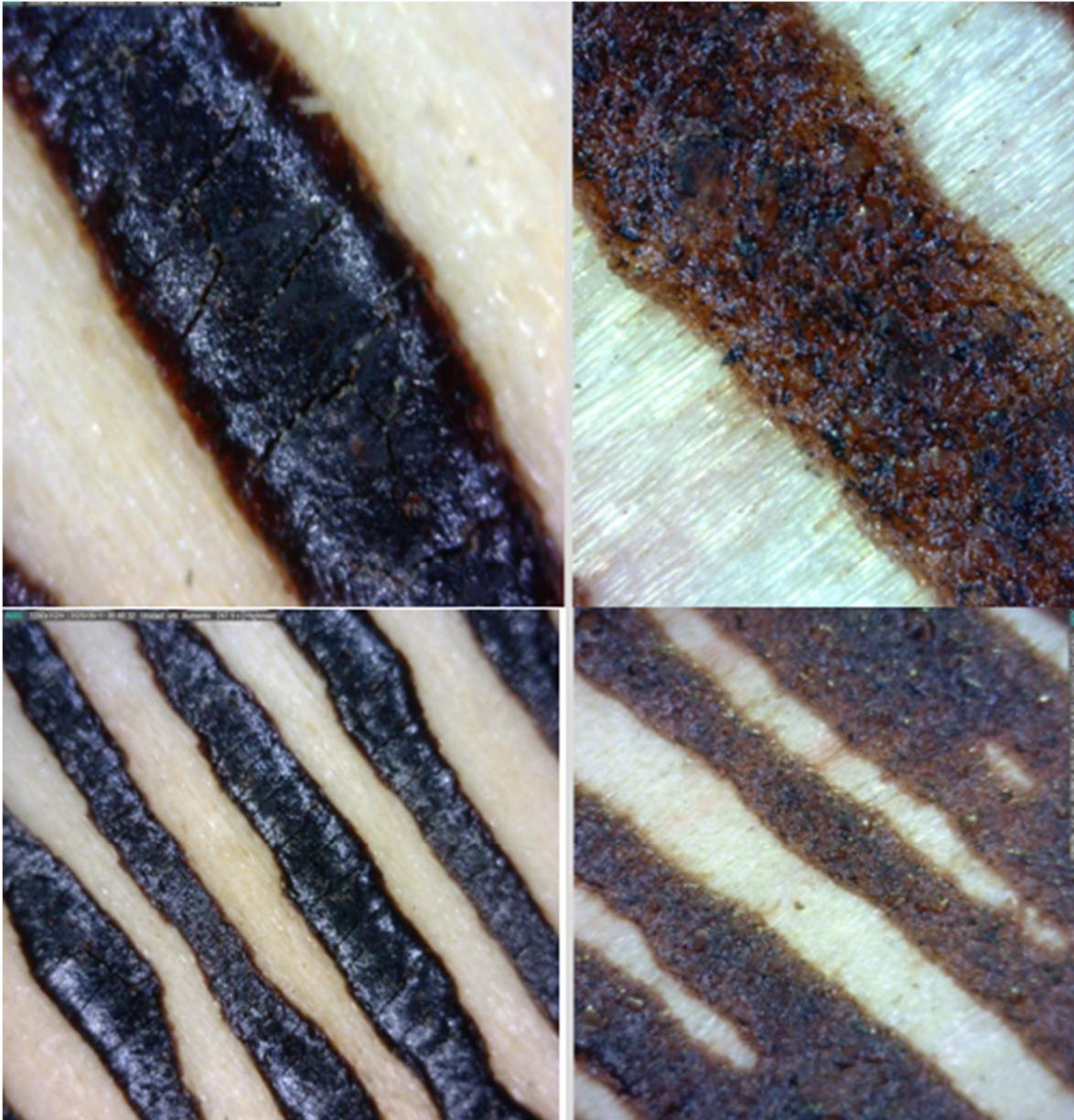
Imagen 6: Contraste entre 2 resinas con filler CCR; izquierda: Se observa el filler aglomerado, como síntoma de una deficiente agitación o bien el uso de un dispersante inadecuado. Derecha: Filler incorporado homogéneamente en la resina.
