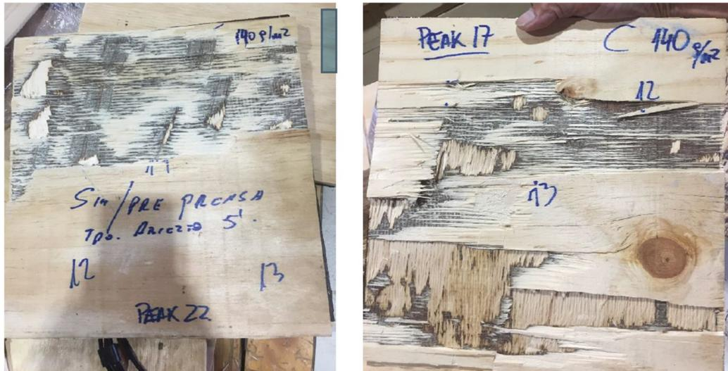
Imagen 13: Resultados de gubia, obtenidos en los ensayos a escala de laboratorio, con humedad promedio de 12-13% y peak de 22%, y promedio 12-13% con peak de 17% en tableros de 9 y 12 mm.
