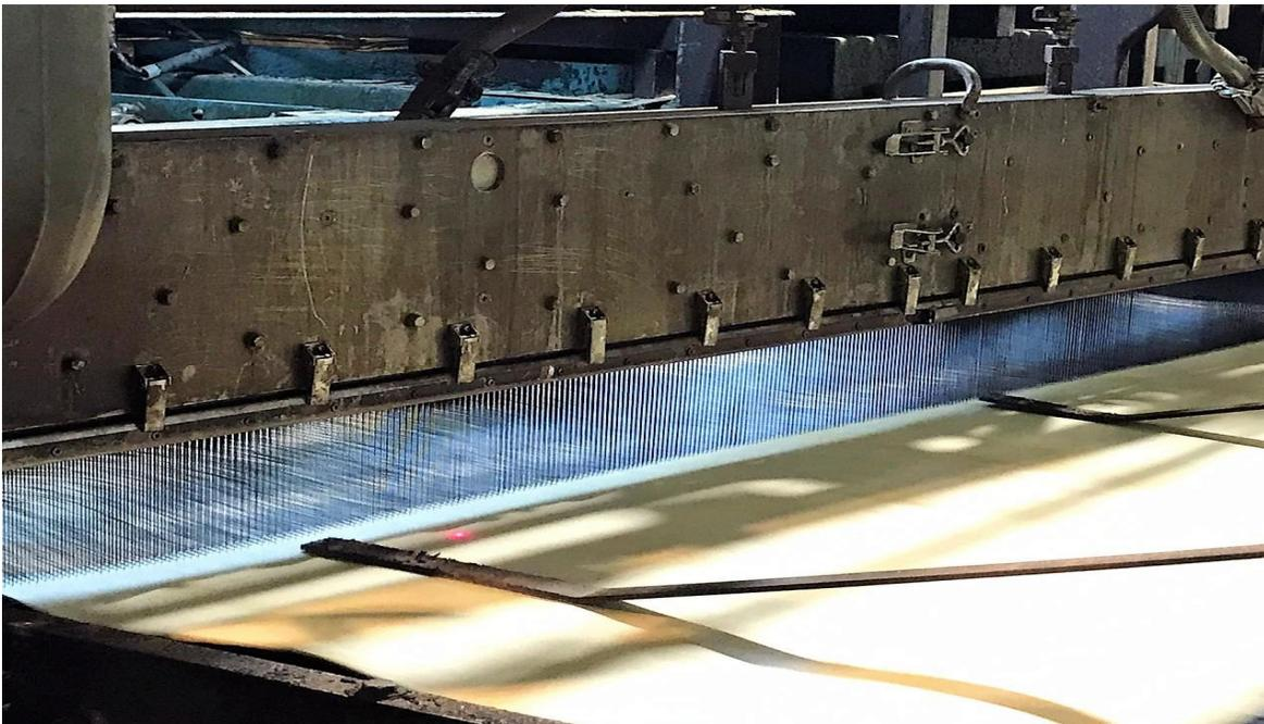
Imagen 5: Sistema de aplicación por extrusión de resina fenol-formaldehído, consta de una cabezal y pequeños orificios llamados lamelas por el cual cae el adhesivo sobre las chapas. Tiene un sistema de recirculación que recoge lo que cae sobre un harnero en constante vibración y lo devuelve al sistema a través de bombas de desplazamiento positivo.
