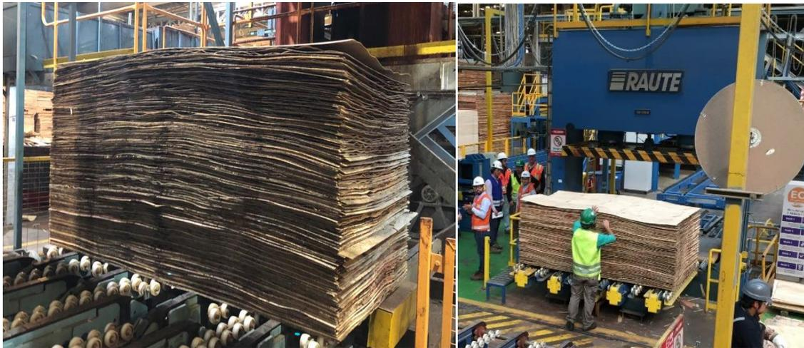
Imagen 8: Tiempo abierto de los tableros una vez aplicado el adhesivo, y control de adherencia o tack.
