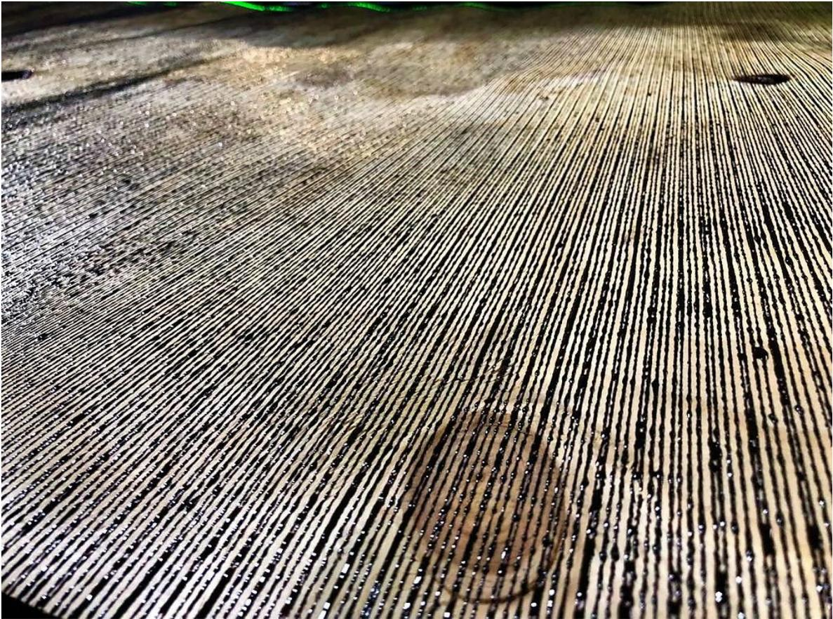
Imagen 7: Aplicación por sistema de extrusión, sobre una lámina o chapa, se mide en  $\text{g}/\text{m}^2$ .
