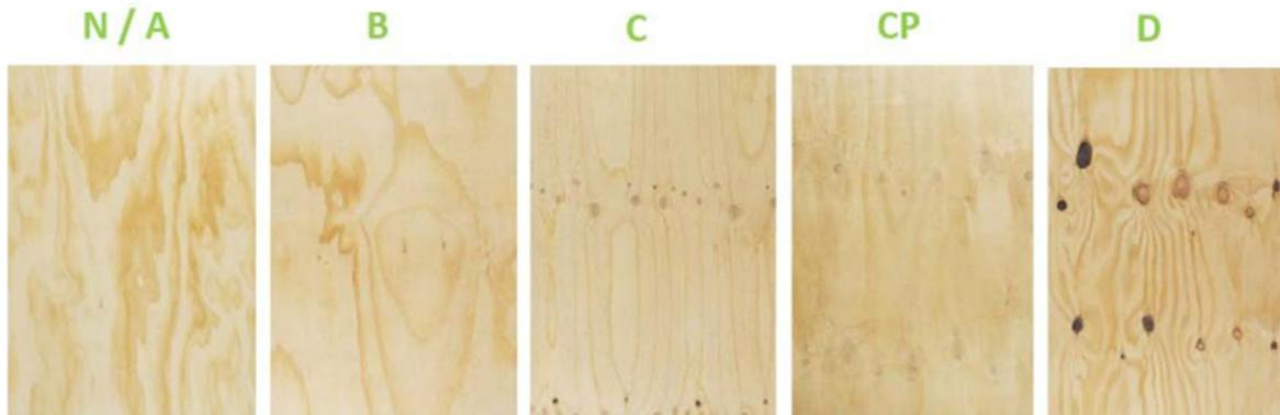
Imagen 2: Clases de Chapas, dependiendo de los defectos, la norma define 6 grados de chapa. (Fuente: Enrique Mac-Manus Arauco 2020, Normativa Plywood PS1-09).
