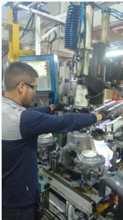
*Ilustración 6 Proceso de clavado de piñon fijo de 5ta y desplazable de 5ta
