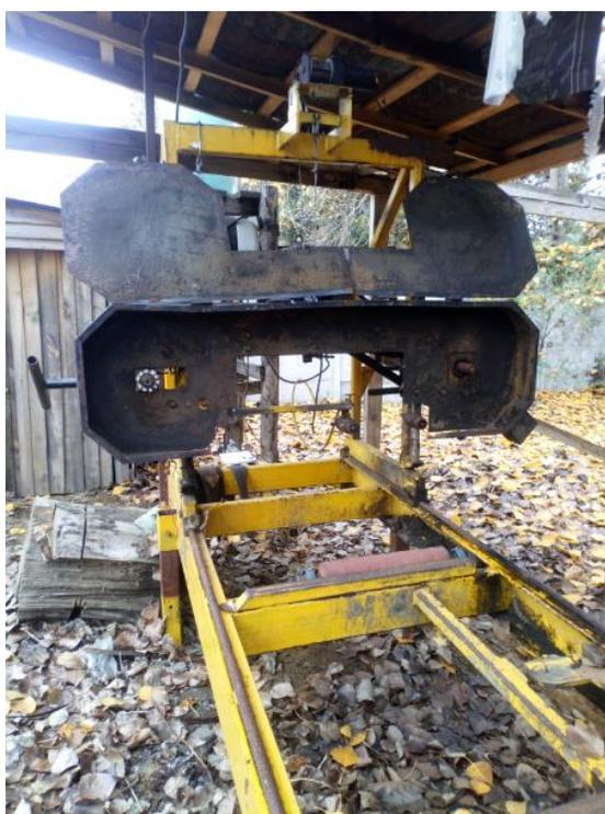
Figura 16: Aserradero de banda horizontal
