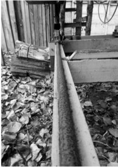
Figura 4: Riel de avance cabezal.
