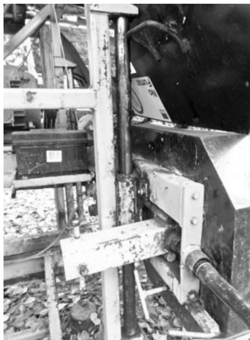
Figura 3: Riel ajuste de altura de corte.
