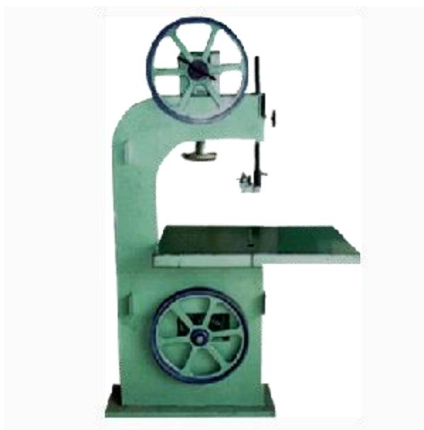
Figura 14: Aserradero de banda vertical.
