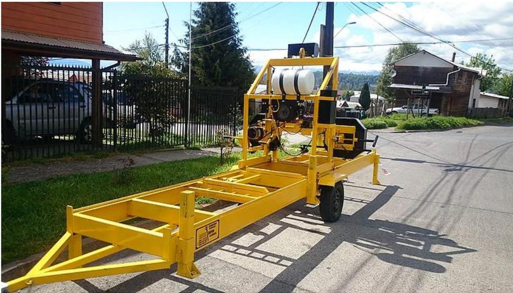
Figura 1: Aserradero de banda horizontal.
