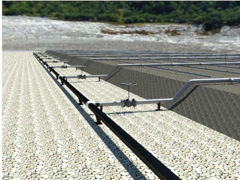
*Figura 16. Esquema de disposición de tuberías en la pila de lixiviación.*
