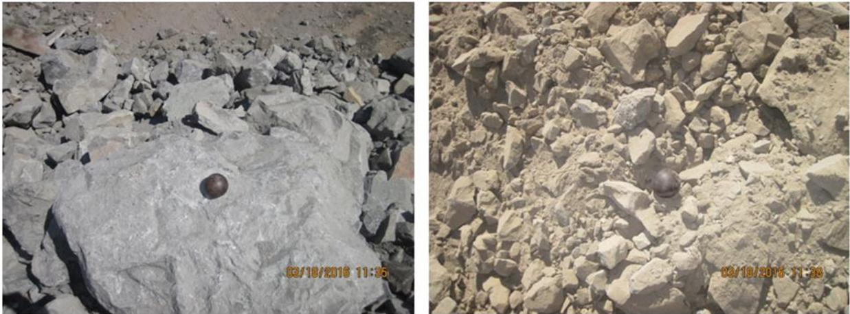
**Figura 4.12.** Imagen in situ de muestra para análisis granulométrico con referencia bola de 3 pulgadas. A la izquierda material de Cinabrio, a la derecha Los Mantos.
