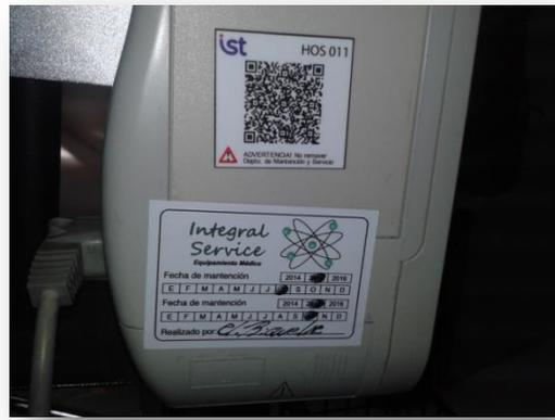
**Figuras (38 y 39): a la derecha ejemplo de implementación de codificación QR para mejorar el control de nuestros equipos dentro del hospital, donde se guarda la información relevante del equipo (Servicio donde se encuentra, Equipo, Modelo, N° de Serie, Año de instalación, N° de inventario), abajo del código QR se puede apreciar el adhesivo que deja la empresa INTEGRAL SERVICE donde aparece la última intervención que se le realizó al equipo.**
