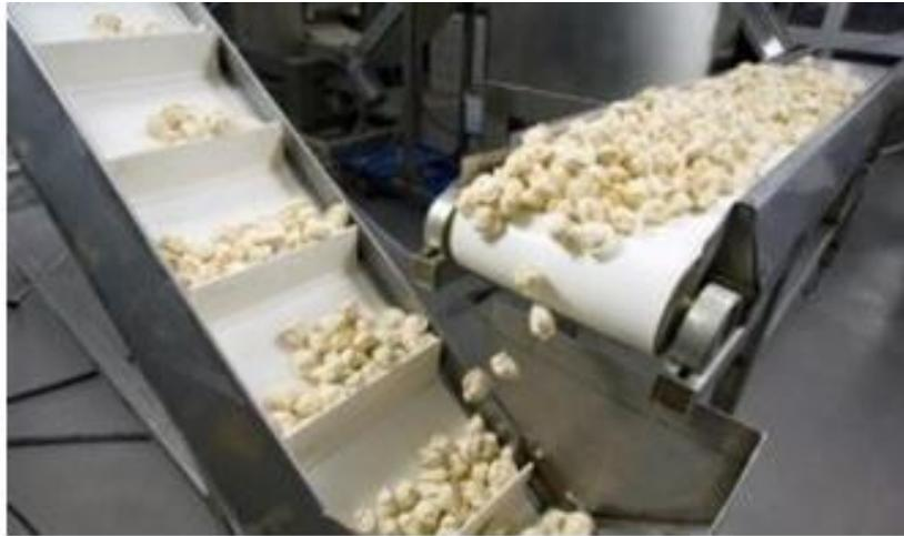
*Figura 2: Cinta transportadora de PVC*
