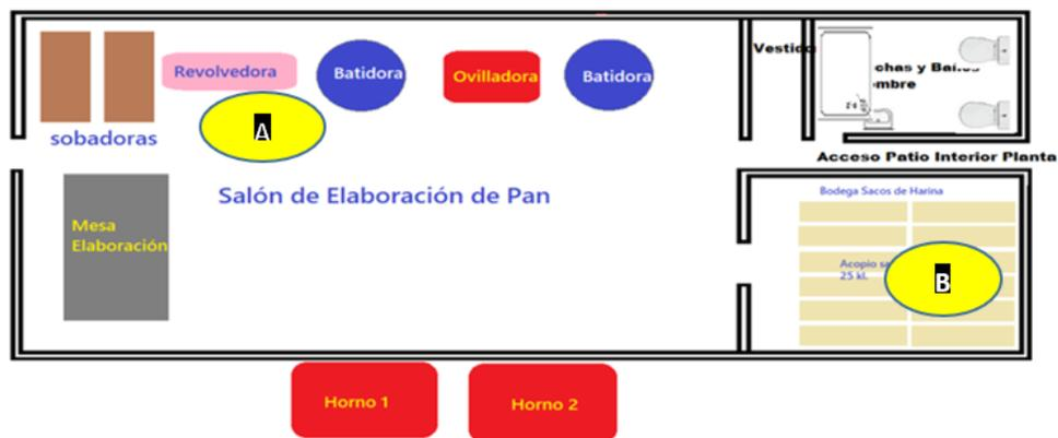
Figura 16: Layout – Recorrido Carro de Carga
