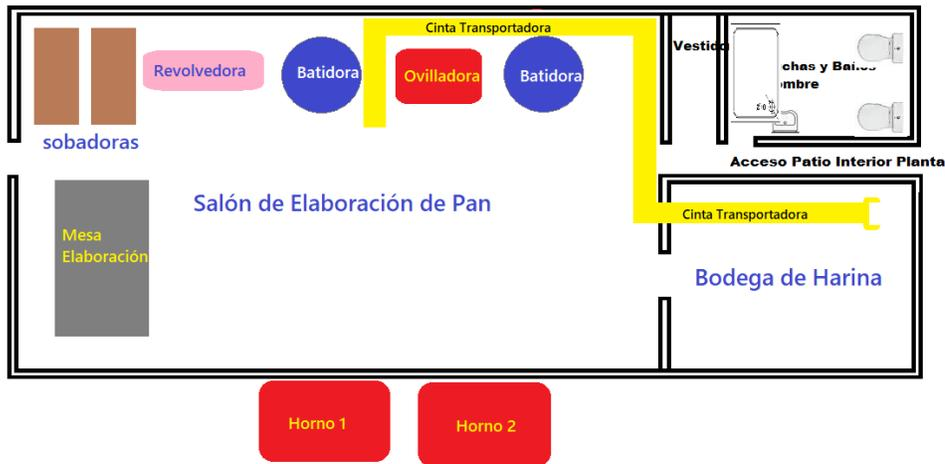
Figura 15: Layout – Instalación Cinta Transportadora
