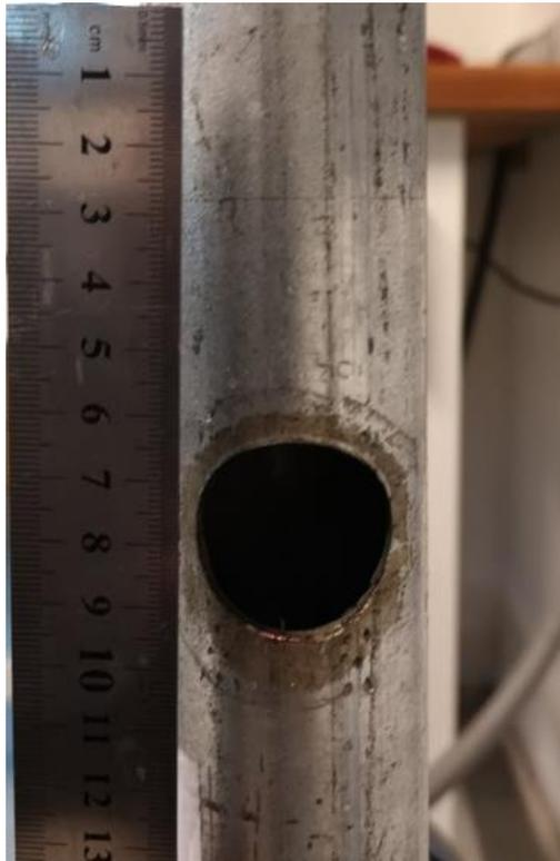
Figura 4-1: Perforación para montaje de sensores en tubería.
