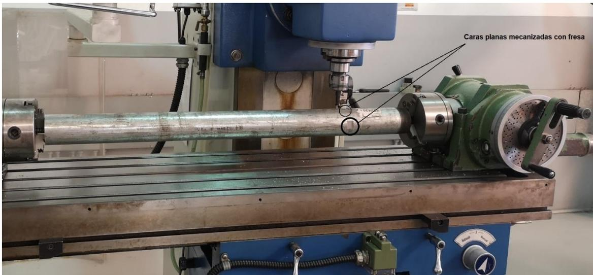
Figura 6-1: Mecanizado de las caras planas y perforaciones roscadas de la tubería de succión.
