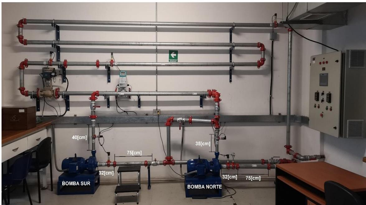
Figura 3-1: Banco de pruebas de bombas centrífugas de la UTFSM, Campus San Joaquín. [Elaboración propia 2018]
