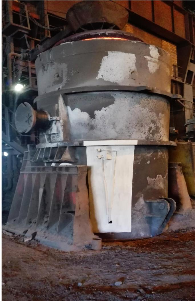
***Figura 2-7 Cuchara de Acero en planta.***
