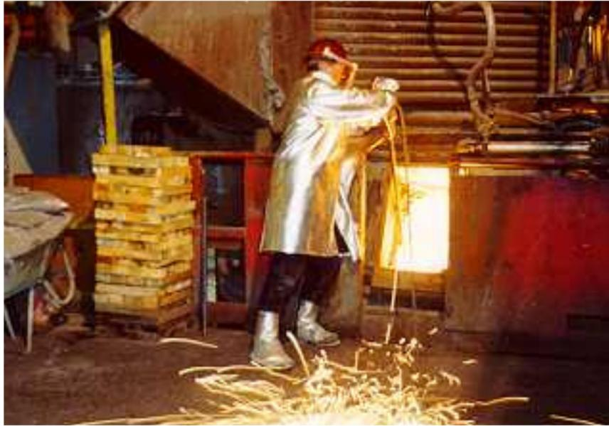
**Figura 1-6** Estación de ajuste metalúrgico secundaria.
