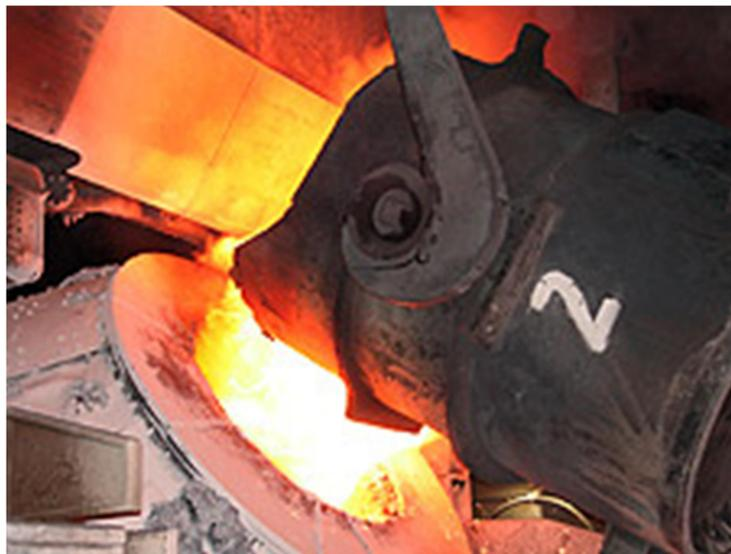
***Figura 1-5*** Convertidor al oxígeno.
