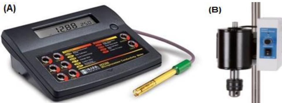
Figura 5.1: Equipos utilizados en el trabajo experimental. (A) pHmetro Hanna HI-8424, (B) agitador mecánico Labtech LS-50.
