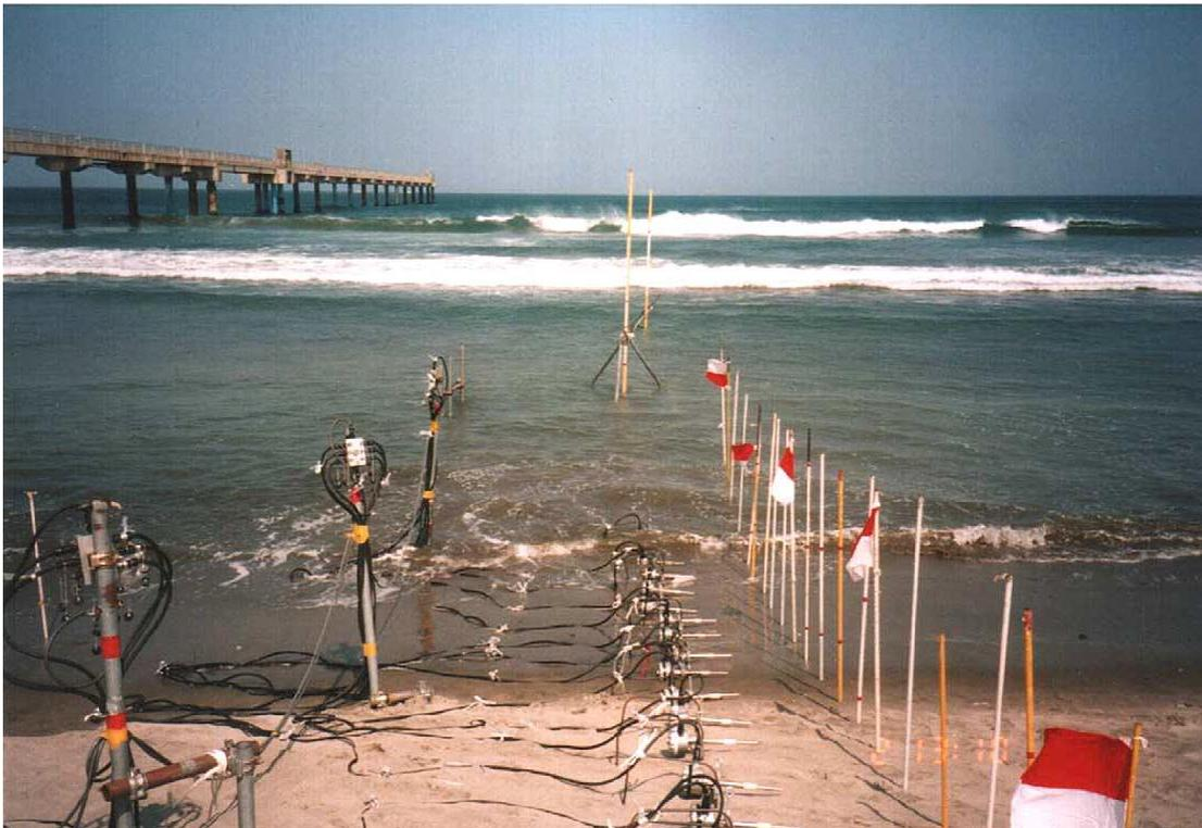
**Figura 2: Instalación montada en la playa japonesa de Hasaki para registrar la hidrodinámica costera y el transporte de sedimentos. Fuente: Larson et al, 2004.**
