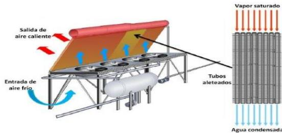
Ilustración 3-13: Funcionamiento Aerocondensador
