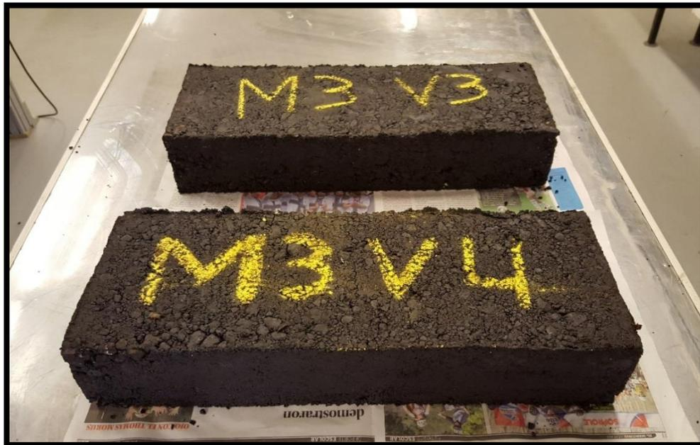
Figura 2.6. Probetas compactadas con rodillo y desmoldadas.
