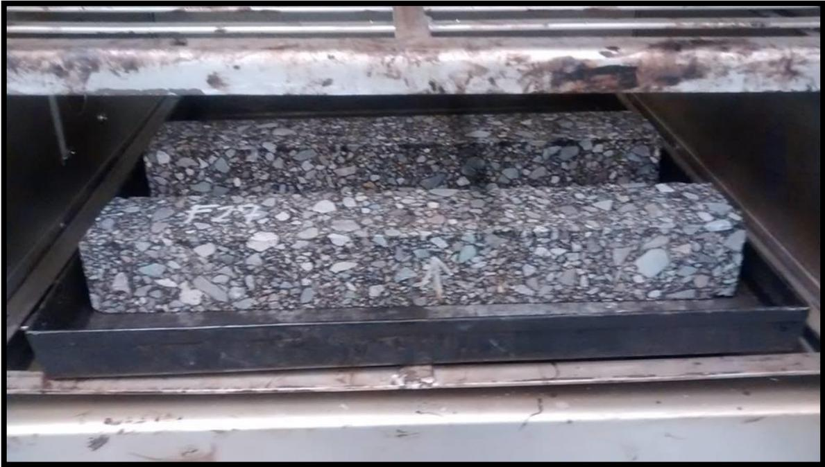
**Figura 4.8. Secado de Probetas elaboradas.**
