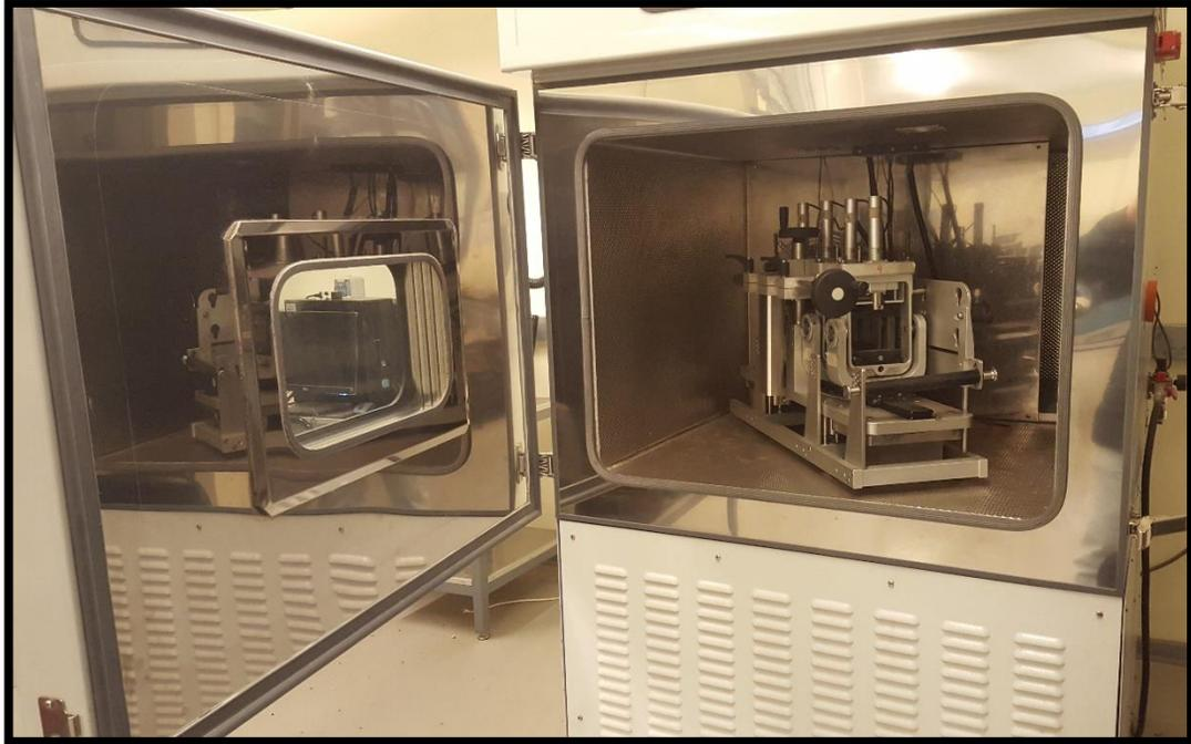
**Figura 4.1. Equipo de fatiga en 4 puntos y cámara de acondicionamiento.**
