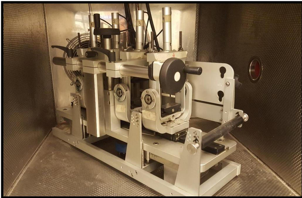
**Figura 4.2. Equipo de fatiga en 4 puntos**
