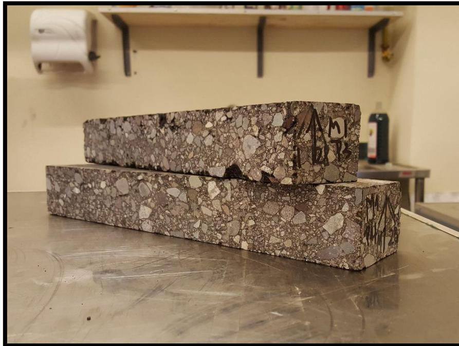
**Figura 4.7. Probetas cortas según AASHTO T321 -14**
