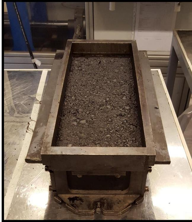
Figura 2.5. Probeta compactada con rodillo.
