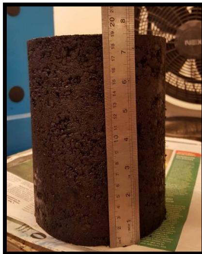
Figura 2.3. Probeta compactada.
