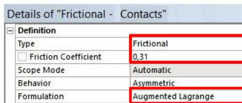
Figura 36: Configuración aplicada para los contactos entre las uniones carpinteras.
