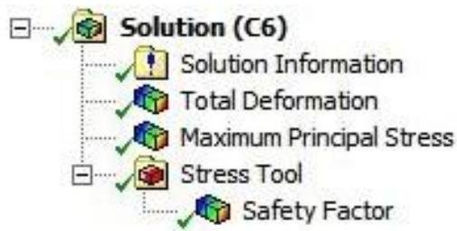
Figura 40: Soluciones requeridas para el análisis estructural en ANSYS.
