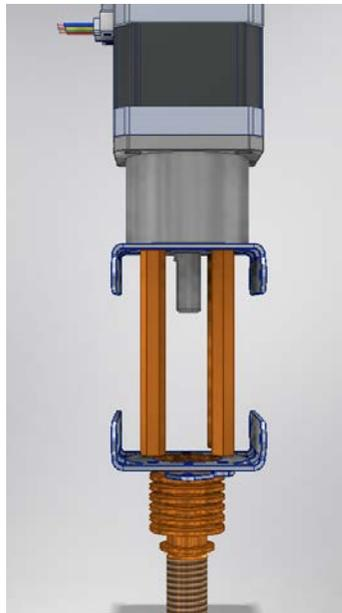
Figura 56: Ensamble Sistema Estructura con Componente Hot-End y Motor
