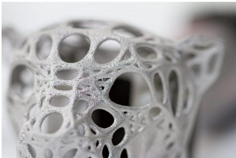
Figura 12: Producto o pieza conformada mediante DMLS, Sintetización Directa láser.
