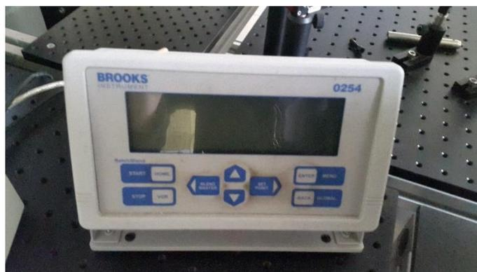
Figura 3.5: Fotografía de la consola digital del controlador de flujos.
