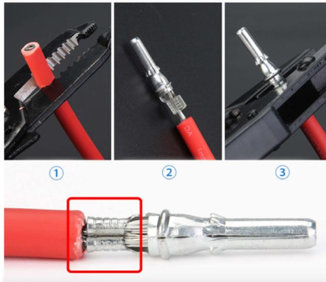
**Figura 6.15:** Método de crimping de cableado al conector MC4.
