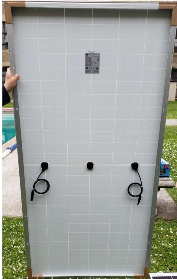
**Figura 6.14:** Vista posterior del panel fotovoltaico, en donde se divisa en el centro la caja de diodos, y a los costados los conectores MC4 incorporados.
