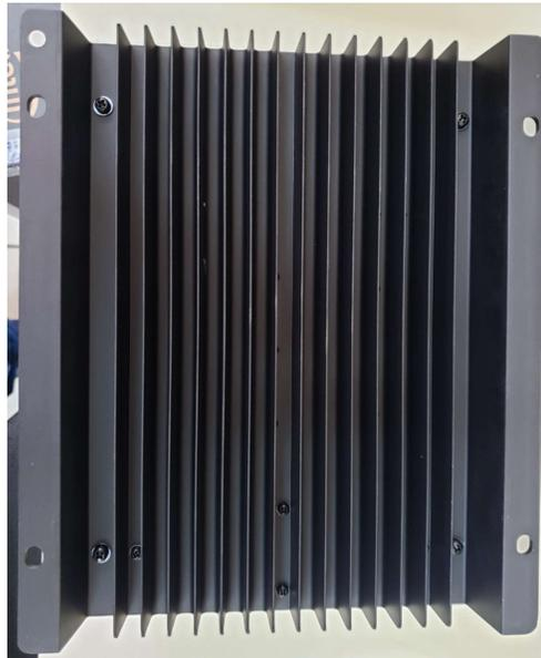
**Figura 6.9:** Aletas posteriores de disipación de calor del controlador de carga.
