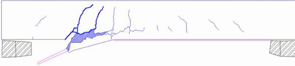
Figura 3.3. *Delaminación del FRP que se extiende hacia el centro.*<sup>15</sup>
