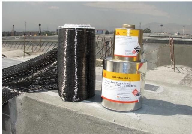
Figura 2.4. *Tejido CFRP y resina epóxica.*
